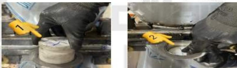
اگر دیدید که پیستون به راحتی داخل سیلندر رفت و داخل دستگاه افتاد اینکار را با پکینگ مشکی رنگ امتحان کنید در صورتی که با ضربه خارج شد پیستون را به تراشکاری برده و جایی را که پکینگ قرار گرفته ۶۴/۵ تا ۶۴/۷ میلی متر میتوانید تراش دهید
