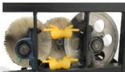
پیچ های اتصال گیربکس به شاسی دستگاه را باز کنید گیربکس را از دستگاه جدا کرده جوش نشان داده شده در تصویر را با سنگ فرز سابیده تا پیچ و واشر آزاد شود پیچ را کاملا باز کنید.
