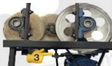
تسمه جدید را گزاشته پیچ های یاتاقان را بسته و کاملا سفت کنید و با پیچ ریگلазی که تعییه شده مهره پایینی را شل و بالایی را سفت کنید تا جایی که تسمه کاملا سفت شود.
