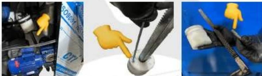
پکینگ دور پیستون را در آورده شافت را جدا کرده پیستون را داخل سیلندر گذاشته و رها کنید در صورتی که این کار را انجام دادید و پیستون به سختی پایین رفت و داخل دستگاه نیفتاد باید پیستون را به تراشکاری برده و ۵/۰ میلی متر از روی پیستون تراش بدهید.
