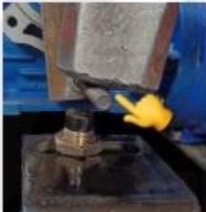
به منظور کارکرد هرچه بهتر و افزایش طول عمر دستگاه هر یک ماه به صورت دوره ای واسکازین گریبکس دستگاه چک گردد. در صورت نیاز واسکازین به گریبکس اضافه گردد.
