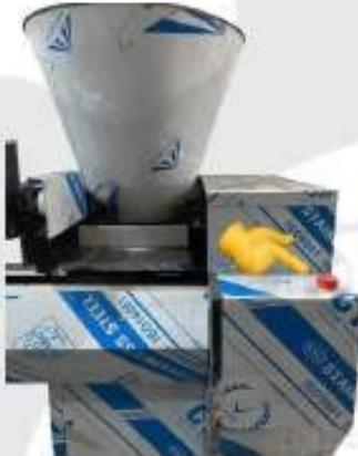
قبل از روشن کردن دستگاه کلید نوار را بزنید نوار گرد کردن شروع به حرکت میکند مقداری آرد کف دست خود قرار داده و بر روی نوار بگیرید تا نوار آرد مال شود این کار را فقط یک مرتبه انجام دهید و برای دفعات بعدی مخزن آردی که کنار قیف قرار دارد را از آرد پر کنید کلیدبرق اصلی را از حالت به ۱ بچرخانید.
