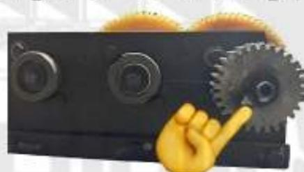
پیچ را بدون واشر بسته و ضربه بزنید (این کار باعث خراب نشدن رزووه ها میشود) دو دنده را از هم جدا کنید.
