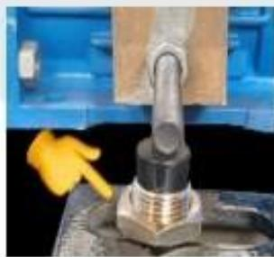
در صورتی که مشاهده کردید سینی دو ردیفه روی حالت جلو یا عقب ثابت نمی ماند و دائم در حال حرکت رفت و برگشتی باشد ابتدا کاور دستگاه را باز نمایید سپس از هم راستا بودن حسگر و سنسور اطمینان حاصل نمایید. برای هم راستا کردن حسگر و سنسور به آرامی به حسگر ضربه وارد کنید تا رو بروی سنسور قرار گیرد.
