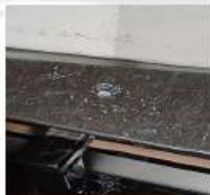
اگر بصورت دوره ای یا با افزایش چانه روی نوار، توقفی در نوار مشاهده کردید دو مهره جلویی را کمی سفت و دومهره پشتی غلتک جلو را بطور یکسان کمی باز نمایید تا نوار در حالت صلب قرار گیرد.
