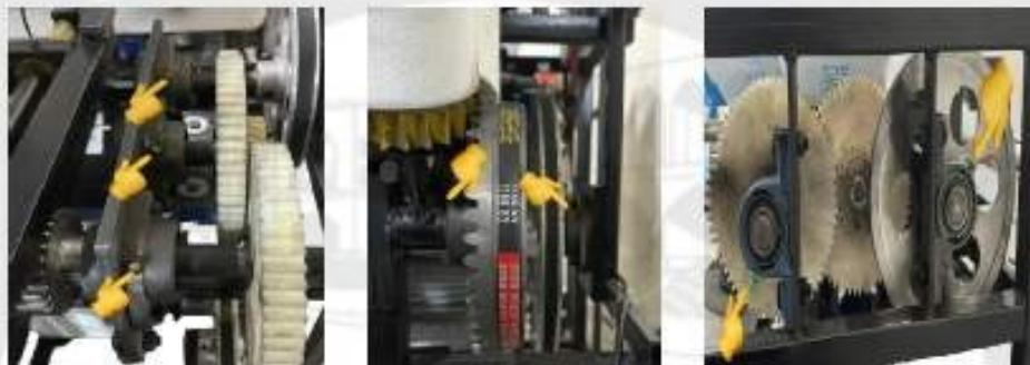
چک کردن و اسکازین گریبکس پیستون ماهیانه یک یا دو بار الزامی است. اینکار باعث عملکرد بهتر و دوام بیشتر دستگاه میشود.
