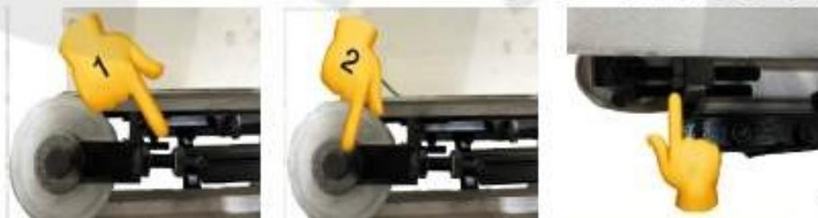
پیچ های سر غلتک عقب را باز کنید غلتک را کاملا بیرون بیاورید ۳ عدد پیچ کف غلتک بسته شده که دنده ها را به غلتک متصل کرده آنها را باز کنید دنده هارا عوض کنید و مراحل فوق را بر عکس انجام دهید.
